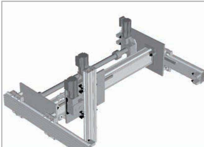
4 - Sistema de três eixos X-Y-Z
